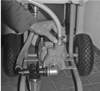
1. Druckschlauch am Pumpenausgang anschließen
