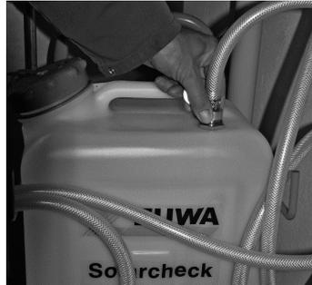
2. Rücklaufschlauch befestigen
