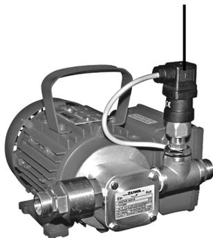
Der Druckschalter schaltet die Pumpe bei Erreichen eines voreingestellten Druckes von 3 bar ab (oberer Schaltpunkt). Fällt der Druck unter den unteren Schaltpunkt schaltet die Pumpe automatisch wieder ein. Die Schalthysterese ist werksseitig mit 30% eingestellt.
