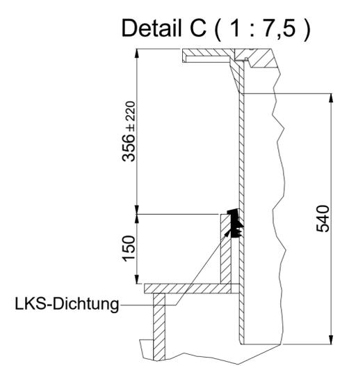
Kessel-Schachtabdeckung DN600, nach Erdbau belastbar bis max. 40t (D400), befahrbar, tagwasserdicht, teleskopierbar
